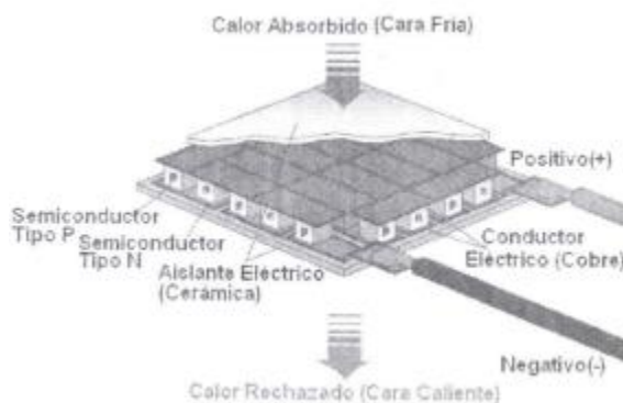
Ilustración 8 Diagrama que muestra la estructura interna de una celda Peltier, donde se observan los elementos semiconductores dispuestos eléctricamente en serie y térmicamente en paralelo.
