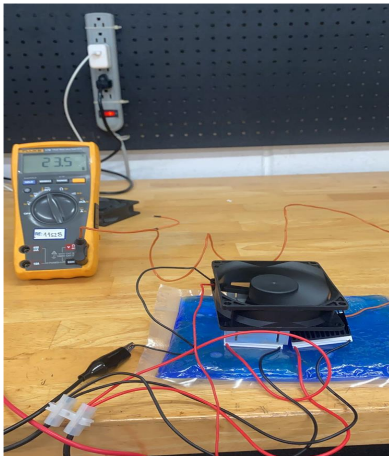
Ilustración 15 Pruebas con un solo ventilador y disipador
