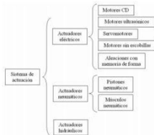
Ilustración 9. Mecanismos de actuación de la prótesis.
