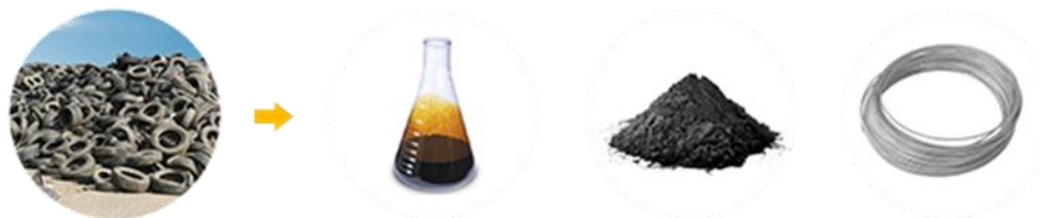
Imagen 1. Compuestos que se puede obtener por procesos de pirólisis con los neumáticos.
