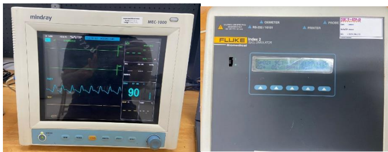
Prueba con un simulador fluke de SpO2 al 90% con un monitor mindray MEC-1000
