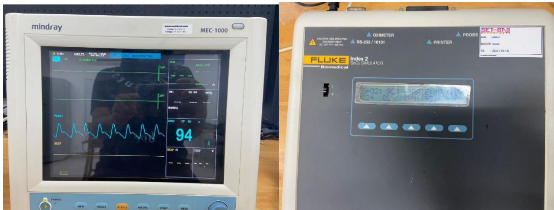
Prueba con un simulador fluke de SpO2 al 94% con un monitor mindray MEC-1000
