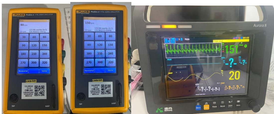
Prueba con un simulador fluke con 80 y 150 imp con un monitor AURORA 8
