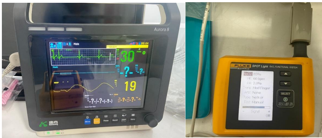
Prueba con un simulador fluke SPORT LIGHT SPO2 AL 85% con monitor AURORA 8
