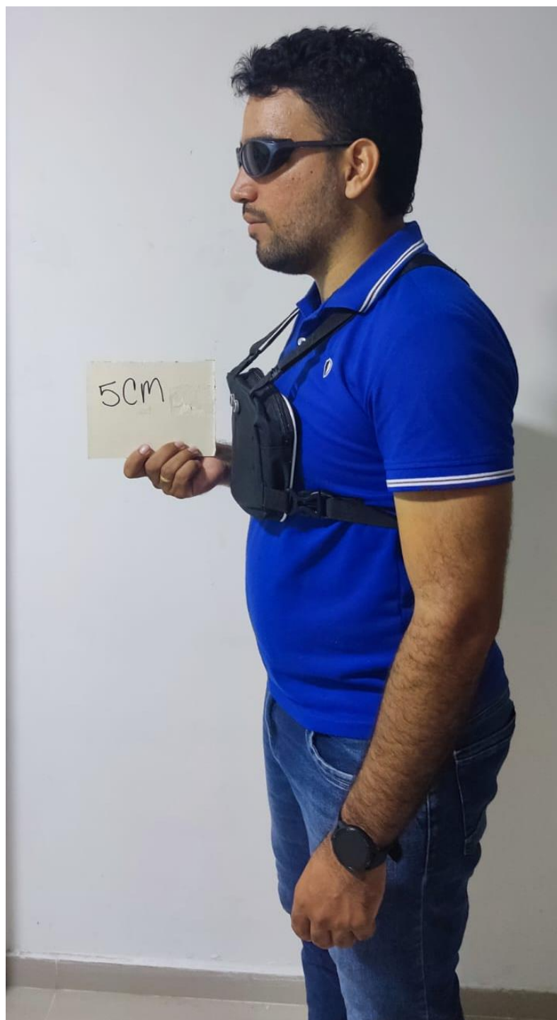
Ilustración 16. Prototipo implementado en una pechera, a 5 cm de distancia
