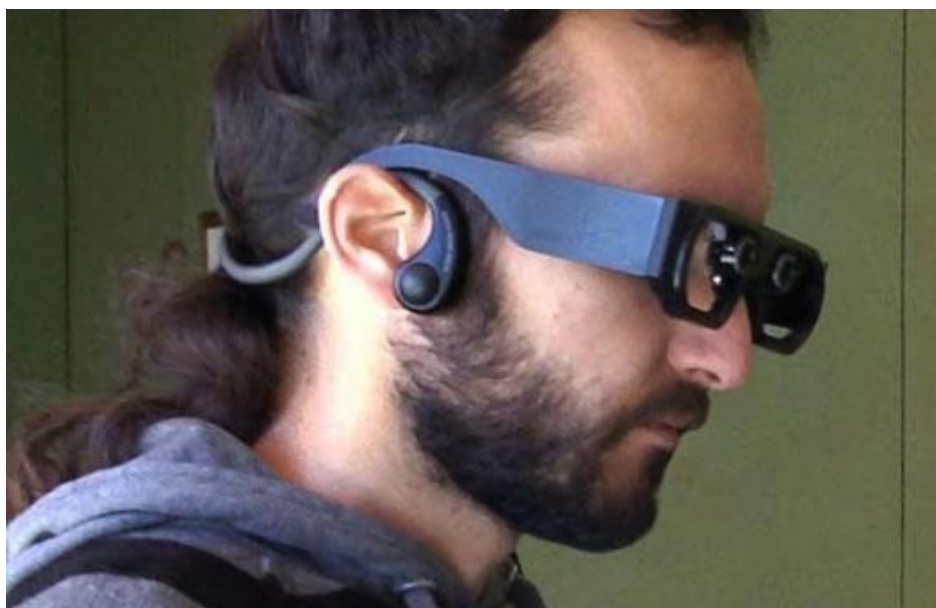
Ilustración 2. Prototipo sónico de ayuda a la ceguera
