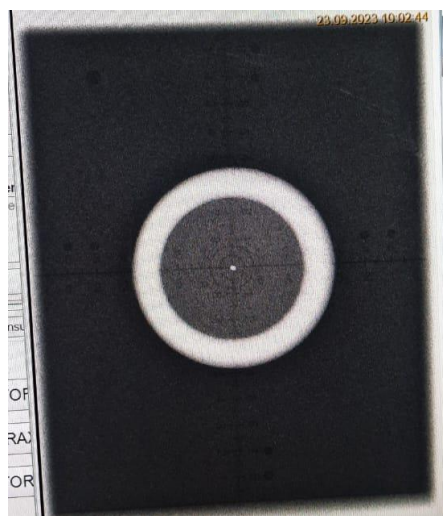
Figura 7. Imagen resultante de la prueba N4 al equipo de Rayos X - TXR SHF-210.
