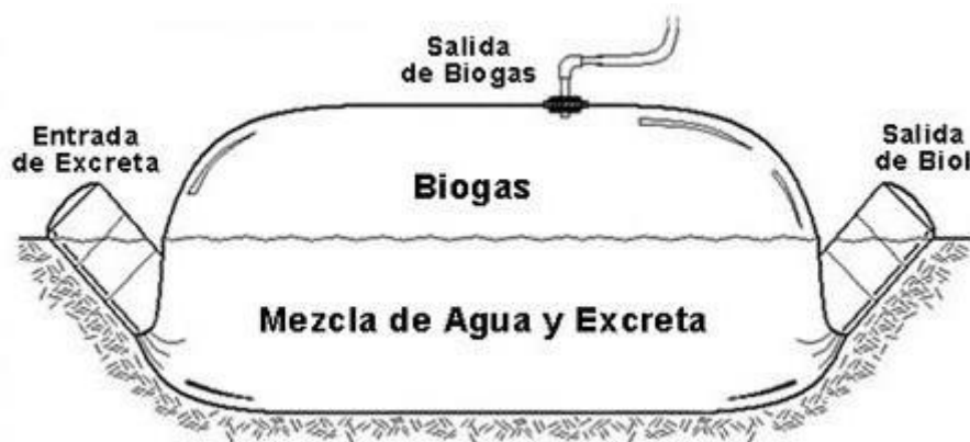
Imagen 3. Diseño de biodigestor semicontinuo
