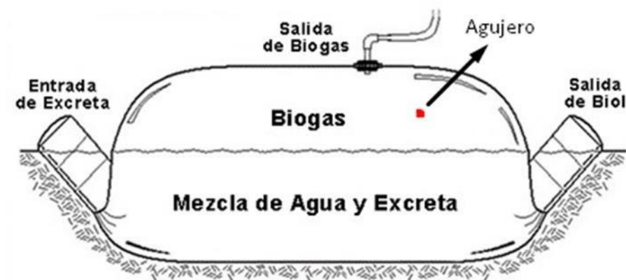
Imagen 4. Verificación de agujeros
