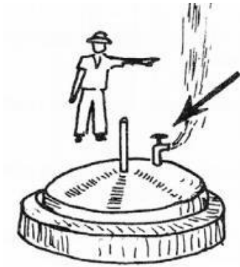
Imagen 6. Abertura y cerrado de válvula
