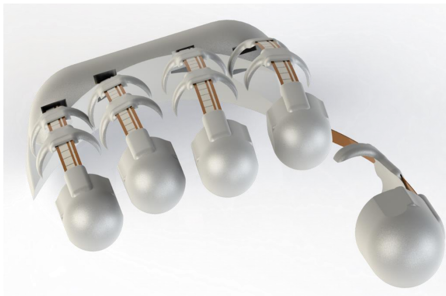
Figura 22. Esquema 3D del guante traductor. vista superior (Imagen propia).
