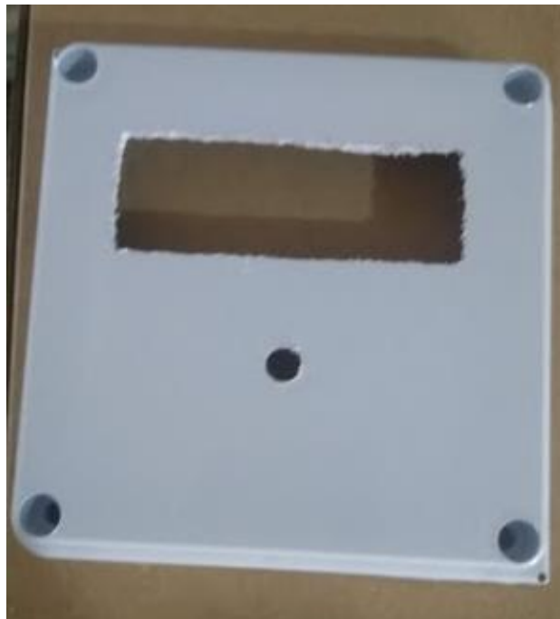
Figura 20. Perforación del Panel Frontal.
